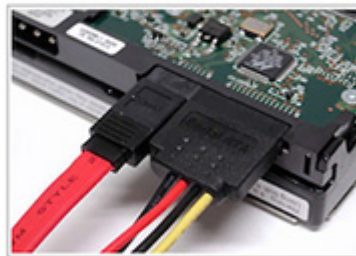
Подключение жесткого диска
