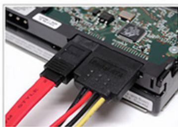
Подключение жесткого диска
